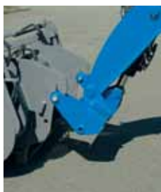
БЫСТРАЯ СЦЕПКА НАВЕСНЫХ ПРИСПОСОБЛЕНИЙ ИЗ КАБИНЫ
