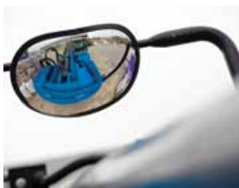
ЗЕРКАЛО ЗАДНЕГО ВИДА ТИПА «РЫБИЙ ГЛАЗ»
