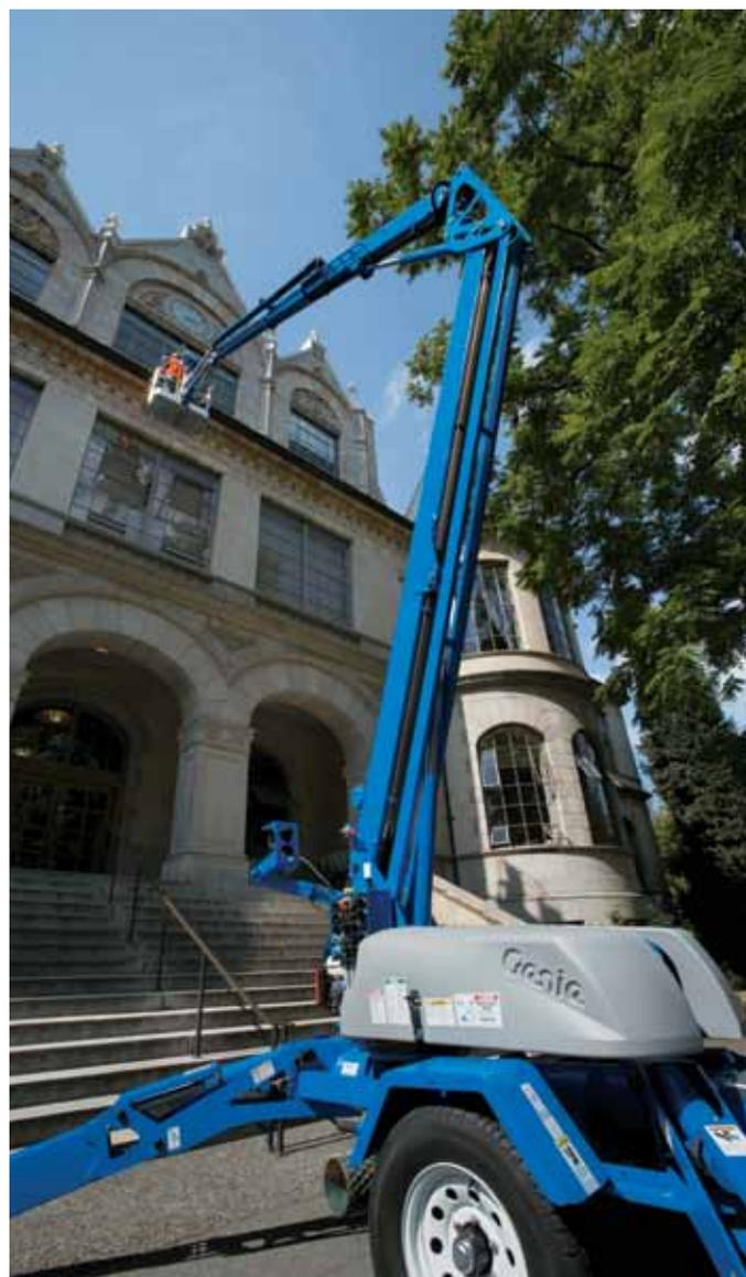
\* Поворот платформы на 90° с помощью механизма ручного поворота на TZ-34, и на 160° с помощью гидравлического поворотного устройства на TZ-50.
